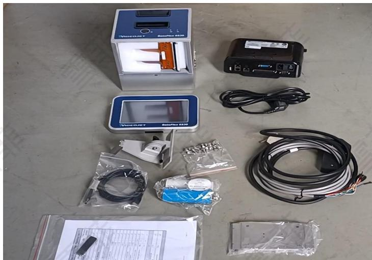
打印机喷头: 负责实际喷码任务, 连接至控制器并固定在打印支架上, 是打印质量的核心组件。
