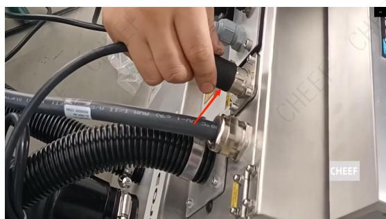
S'il y a un encodeur et un syncher, connectez-vous ici, 3 trous sont photoélectriques, 4 trous sont un encodeur, si certains peuvent se connecter ici.
