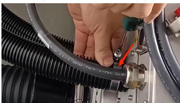
Le câble de données du contrôleur est connecté ici, et la vis est bien verrouillée.
