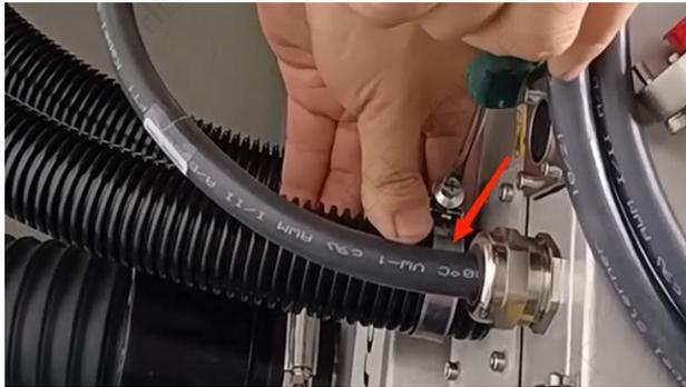
Кабель для передачи данных контроллера подключен здесь, а винт плотно заблокирован.
