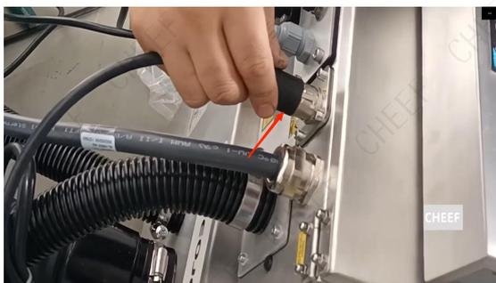
Если есть кодировщик и синхронизация, подключитесь сюда, 3 отверстия фотоэлектрические, 4 отверстия - это кодировщик, если некоторые могут подключиться здесь.
